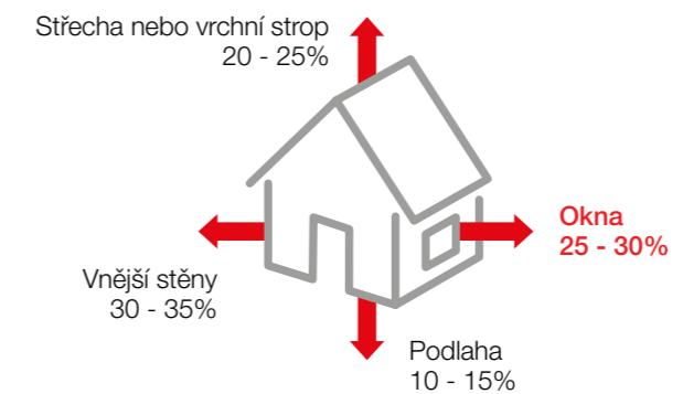
Obr.: Příklad tepelných ztrát prostupem
